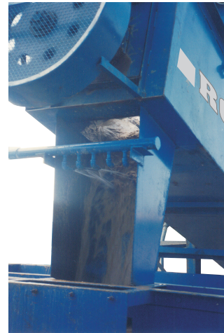
Fig.- 3.- Vista de Descarga de una Lavadora de 1 Helicoide.
